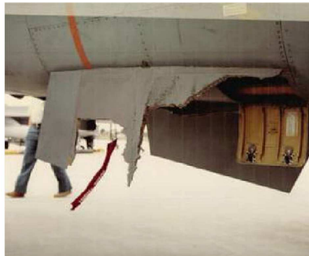
(b) Ventral fin failure
