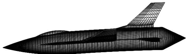
(d) Fuselage Vertical Bending
